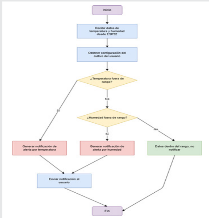
Figura 5: Diagrama de flujo del proceso de validación de rangos de cultivos y generación de alertas.
